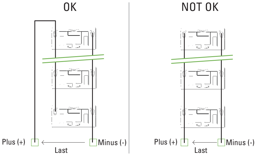
Abbildung 18. Parallelschaltung von Li-Ionen-Batterien
